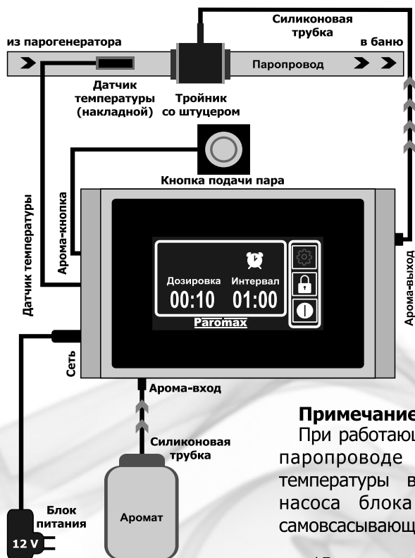
Рис. 2. Схема подключения диспенсера ароматов
